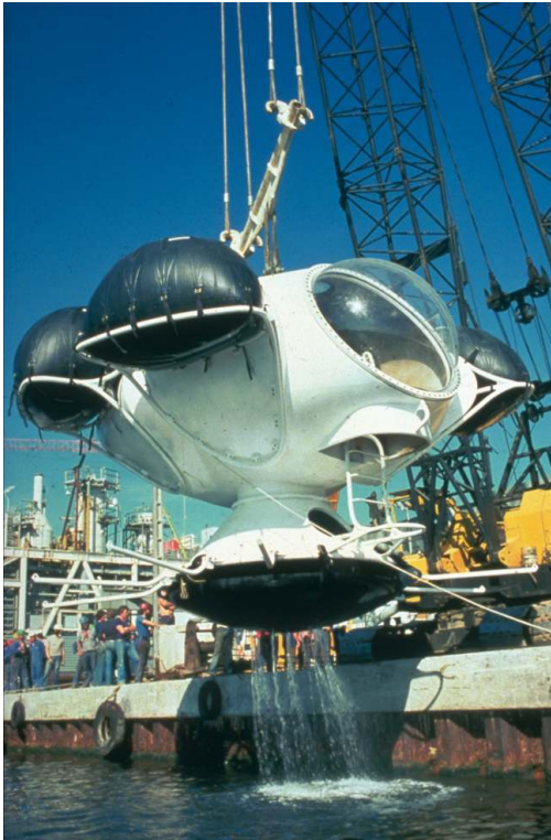
Fig. 6 : Mise à l'eau de Galathée en 1977
