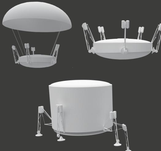
Après le largage du module par la mission martien, le bouclier thermique va commencer à emmagasiner la chaleur du au blast, la transmettrant en partie à la coque/foreuse thermique installer sous le module.
