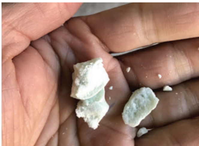
Photo 1-194 Isolation en Bio-Polyurethane . Crédit : FYu
