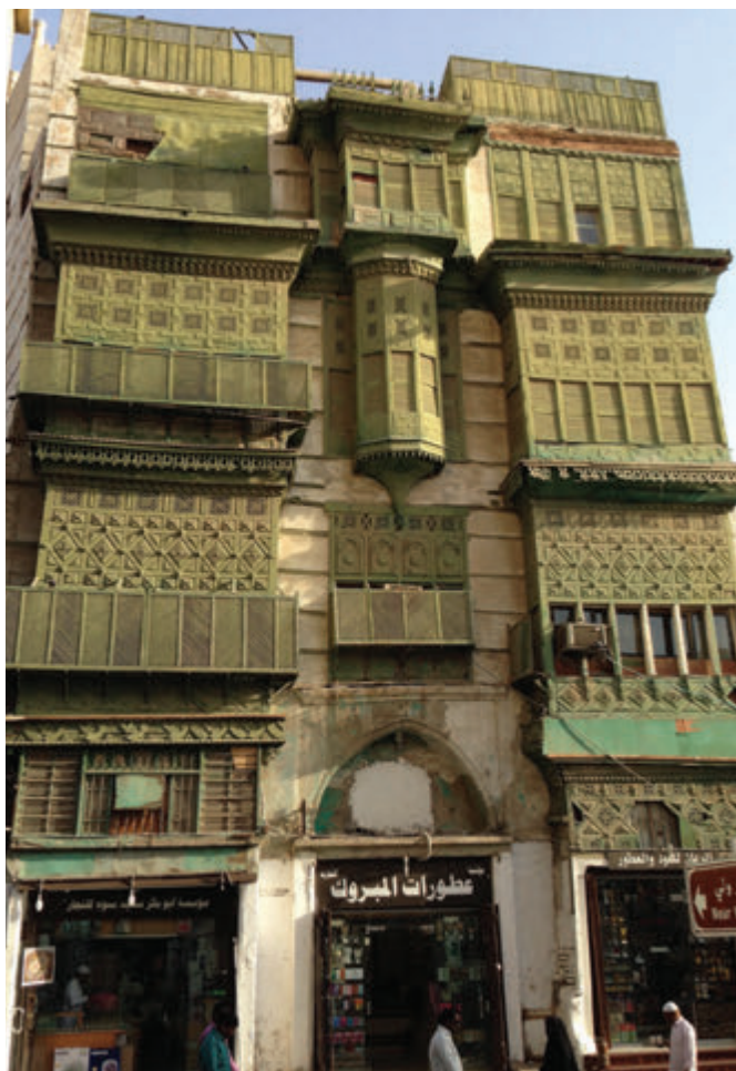
Photo 1-31 constructions en pierre de corail, des façades décorées de bois sculpté et des moucharabieh pour assurer la ventilation des bâtiments. Crédit : FYu
