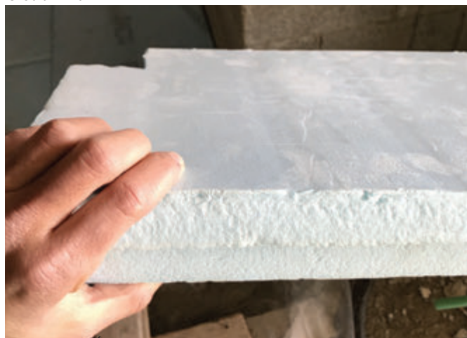
Photo 1-197 Epaisseur de l'isolation en XPS utilisé pour les parois en contact avec la terre. Crédit : FYu
