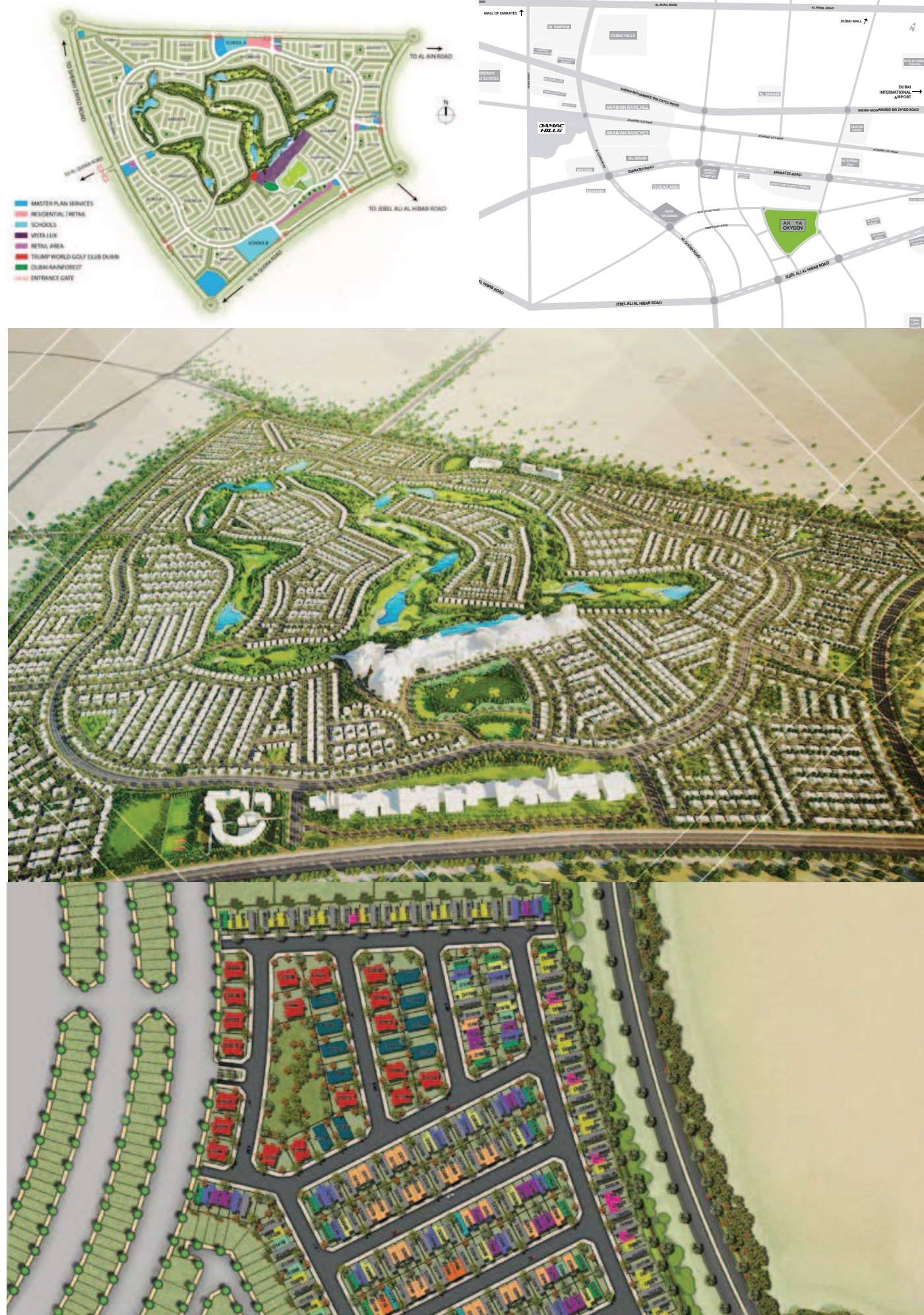
Figure 4-31 Plan urbain de l'opération AKO_YA OXIGEN à Dubaï proposé et en construction par la société DAMAC avec une prise en compte de l'orientation uniquement dans l'organisation des dessertes du lotissement, et pas en rapport avec le soleil.
